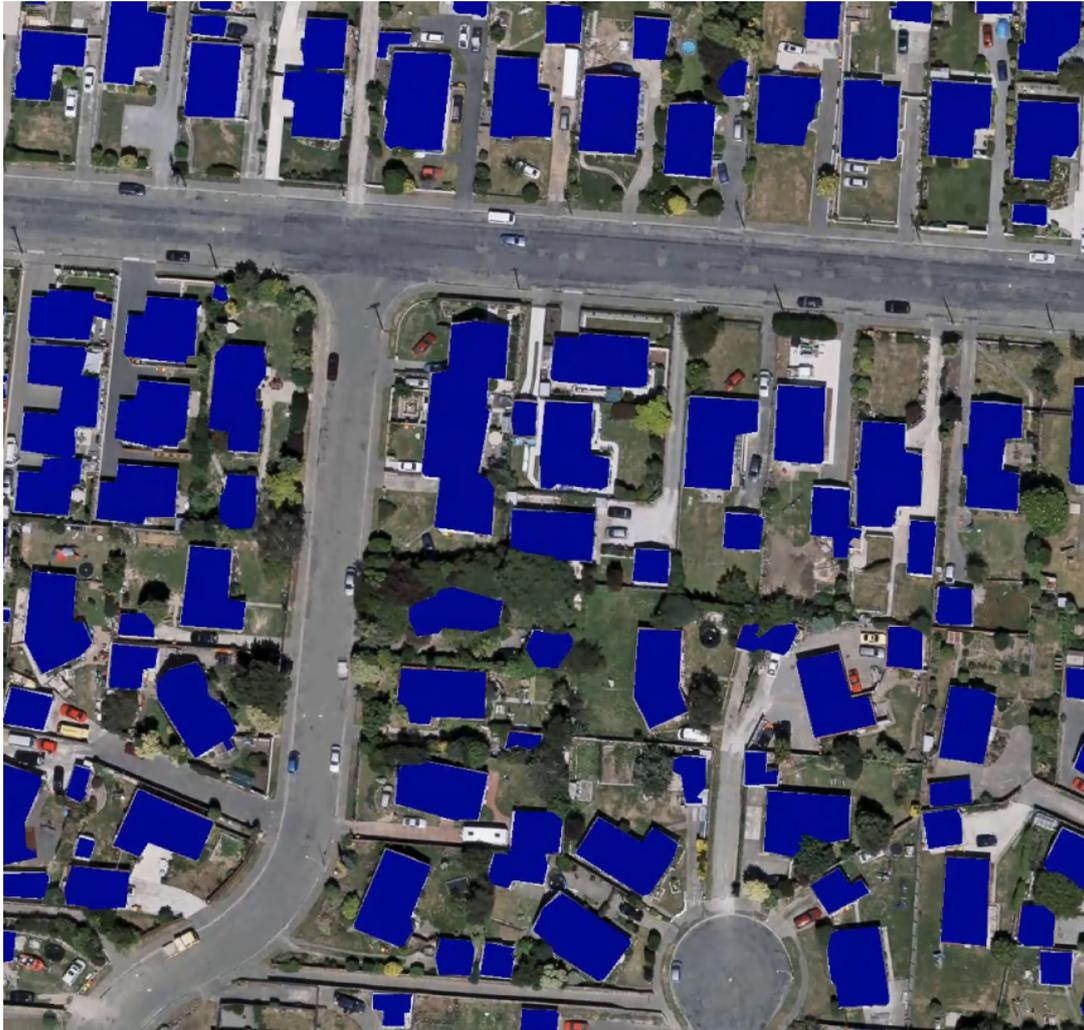
이 유형의 작업에는 정사 사진 및 정사 사진+DSM 감지기만 사용할 수 있습니다. DSM의 역할은 대상 요소의 높이에 따라 분류를 최적화하는 것입니다. 예를 들어, 건물 설치 공간이 있습니다. 감지기가 교육되었고 단일 정사 사진이 아닌 정사 사진+DSM 케이스에서 제출된 경우 이러한 추출이 더 정확합니다.
