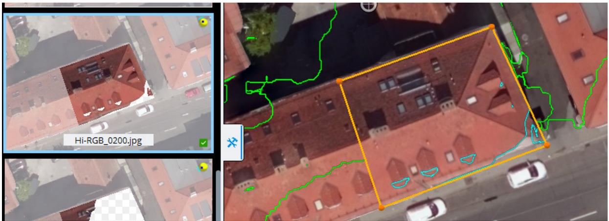
그림2 녹색 선은 정사 사진 모자이크의 현재 영상 경계선입니다. 청록색 선은 선택한 이미지를 다각형 내부에 적용하면 도입되는 새로운 영상 경계선입니다.
