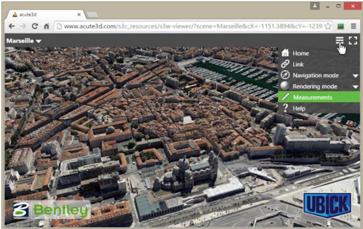
모델이 항상 참조되면 선택한 공간 참조 시스템에 GPS 좌표가 표시될 뿐만 아니라 고도 및 거리도 미터로 표시됩니다. 그렇지 않으면 거리 및 위치가 3D 모델의 공간 참조 시스템에 상대적으로 표시됩니다.
